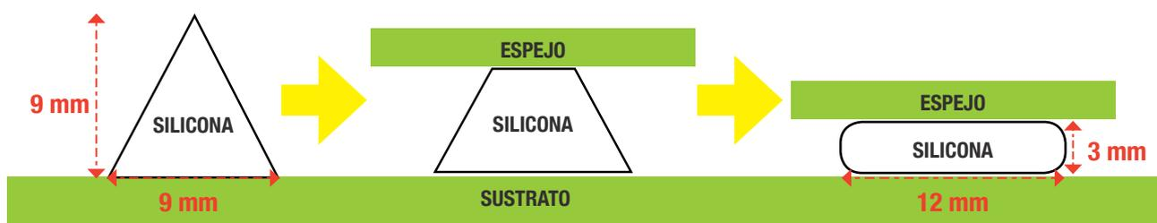
En instalaciones mediante adhesión químicas, se recomienda no utilizar siliconas de base acética (que posee olor característico de vinagre), ya que estas realizan su proceso de curado a través de la volatilización de solventes ácidos, pudiendo disolver la pintura de los bordes de los espejos, reduciendo drásticamente su durabilidad.
