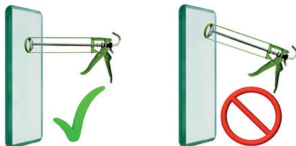
2. Se recomienda utilizar una boquilla cortada en V que permite un mejor flujo del producto y formar cordones triangulares, estos cordones permiten una distribución equitativa del producto y deben tener un espesor mínimo final de 3 mm.
