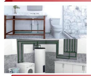
Polipropileno copolímero Random (PPR): Se compone de polipropileno y de etileno (5 a 30%). Alta resistencia al impacto, baja cristalinidad y temperatura de fusión (145-155°C) y alta flexibilidad. Resistencia a la presión, se utiliza en sistemas de piping y fittings para transporte de agua fría y caliente.
