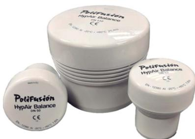
Las Válvulas de Admisión de Aire de Polifusión HypAir Balance son dispositivos que se utilizan para resolver de manera confiable y segura los problemas ocasionados por las presiones negativas y los gases en baños y cocinas que son ocasionados por una ventilación insuficiente. Estos dispositivos ayudan a la incorporación del aire necesario en los sistemas de descarga, y contribuyen al uso de menores caudales en la evacuación de las aguas residuales.
