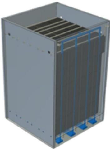
Los sistemas de Bioreactores es el más utilizado en comunidades, pueblos y fábricas para tratamiento automatizado de aguas residuales de más de 100 m<sup>3</sup>/día. El sistema está diseñado para su colocación en tanques de hormigón fundido in situ. Sus capacidades van desde 100 a 3.000 m<sup>3</sup>/día o de 500 a 20.000 personas por instalación, retirando más del 90% de la materia orgánica con un proceso sin olor y sin químicos.
