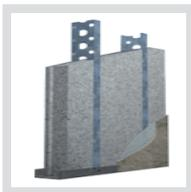
El panel puede ser utilizado con el perfil de acero expuesto por ambas caras, como así también con una cara oculta con Poliestireno Expandido, esto último es recomendado para recubrimientos de fachadas ya que produce una superficie exterior continua y aislada lo que evita dilataciones por variaciones de temperatura en los diferentes materiales, riesgos de condensación, etc. y también facilita el uso de canterías u otros.
