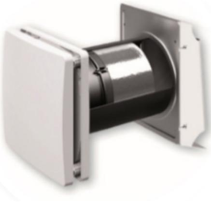
Sistema compacto descentralizado de ventilación mecánica con recuperación de calor. Cubierta interior Cubierta interior "Flair" de 233 x 233mm con filtro G4 integrado, con función de dirección de flujo de aire y cierre rápido, color blanco RAL 9010. Cubierta exterior Cubierta de protección contra la intemperie "Compact" 203 x 276 x 80mm, de metal, color gris RAL 9006.
