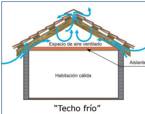
Figura 5.5: Configuración de techo frío.
