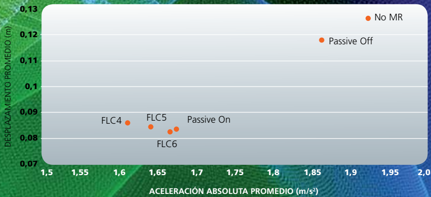
FIGURA 7. AMORTIGUAMIENTO DE 12%, 4 AMORTIGUADORES MR
