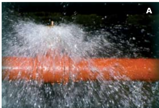
FIGURA 2. FUNCIONAMIENTO DE LOS ROCIADORES EN FUNCIÓN DE LA PRESIÓN DEL AGUA DISPONIBLE.
