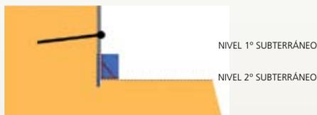
**14.** Se instala el moldaje. Esta vez, se le incorpora una consola, la cual servirá de apoyo a las losas.
