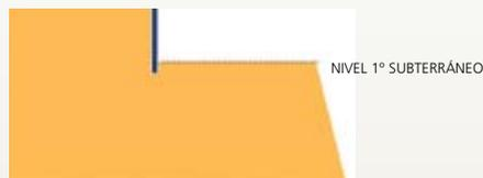
**5.** Una vez instalada la enfierradura, se deberá rellenar con tierra hasta llegar al nivel del sello. Así, al hormigonar el muro, el hormigón llegará solo al sello de excavación de la plataforma.
