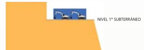
**3.** El sello de excavación de la primera plataforma será el fondo de losa del cielo del 2º Subterráneo.
