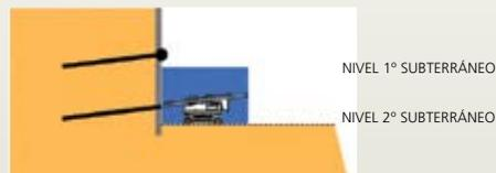
**16.** Una vez descimbrado el moldaje, se procede a la perforación e instalación de los anclajes.
