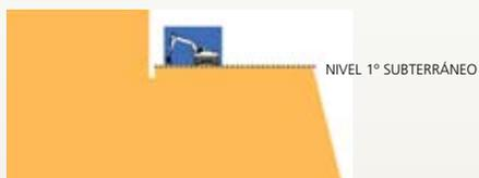
**4.** Una vez llegado el sello, se debe excavar una zanja, que será para dejar los fierros pasados de los muros para los empalmes verticales.
