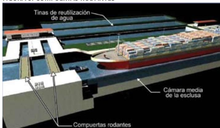
Las esclusas utilizarán compuertas rodantes y remolcadores para maniobrar y asistir a los buques durante el proceso de esclusaje.
