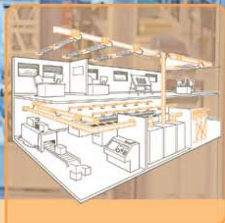
Desde el transformador hasta las luminarias, la canalización rígida prefabricada Zucchini es un perfecto y completo sistema de distribución de energía de 25 a 5000 A.
