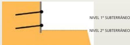
**17.** Una vez fraguado el mortero de inyección, se procede a tensar los cables. A continuación, las faenas se repiten según la cantidad de subterráneos.
