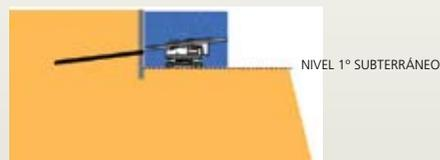
**8.** Una vez descimbrado el moldaje se procede a la perforación e instalación de los anclajes.
