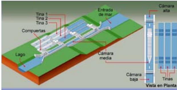
Vista isométrica del complejo de esclusas con sus compuertas y tinas para reutilización de agua. En el dibujo lateral se muestra una vista en planta de una de las cámaras típicas con un buque.
