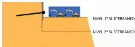
**10.** Se procede a la excavación del segundo sello de trabajo, el cual es el fondo de losa del cielo del 3º subterráneo.
