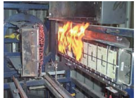
Ensayo de reacción al fuego de materiales para la construcción.
