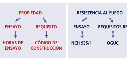
**FIGURA 2. Esquema de Ensayos y exigencias en general (izquierda) y específico para RF en Chile (derecha).**
