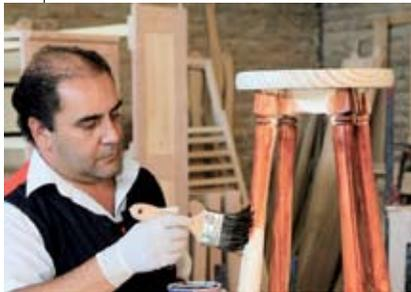
La tinta para madera se puede usar tanto en interior como exterior, se puede aplicar con brocha o paño y posee una cartilla de 6 colores. El sellador y la laca para madera han sido fabricadas para ser utilizadas en ventanas, puertas y muebles interiores y se caracterizan porque, según el proveedor, secan en 30 minutos (en verano). El sellador viene listo para usar, sirve para impregnar y tapar el poro de la madera, bajando la absorción y facilitando el lijado.
