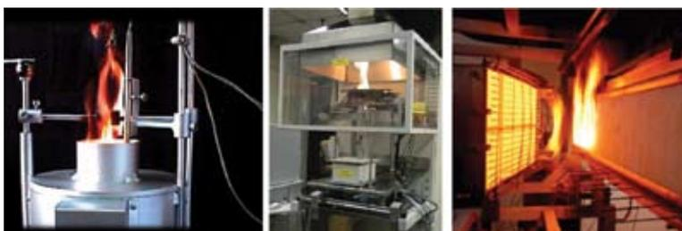
**FIGURA 6.** Algunos ensayos de reacción al fuego: (1) no combustibilidad, (2) como calorimétrico, (3) ensayo de ignición y propagación de llama.
