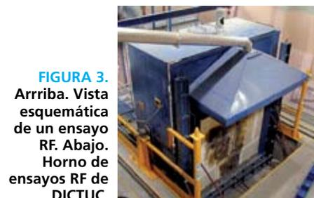
**FIGURA 3.** Arriba. Vista esquemática de un ensayo RF. Abajo. Horno de ensayos RF de DICTUC.
