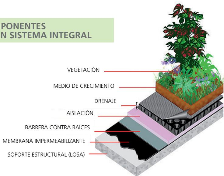
instalación de planchas de poliestireno de alta densidad. Se recomienda que esta aislación tenga un espesor de 5 centímetros.
