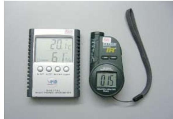
**Los instrumentos para la toma de mediciones consisten en un termómetro-higrómetro ambiental y un termómetro infrarrojo para la toma de temperatura de superficie de muros.**
