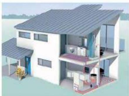
Arriba: Sistema aerotérmico interior con distribución para calefacción y acumulación de A.C.S.
