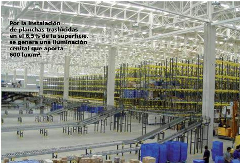
Por la instalación de planchas traslúcidas en el 6,5% de la superficie, se genera una iluminación cenital que aporta 600 lux/m<sup>2</sup>.
