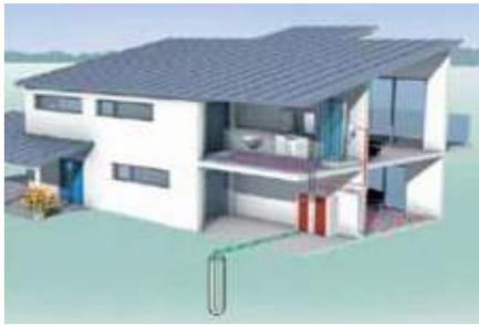
**Arriba: Sistema geotérmico con diseño vertical. Utiliza la energía del agua subterránea.**
