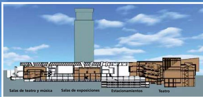
Elevación que muestra las distintas áreas del edificio.
