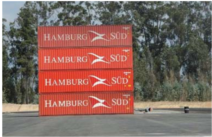
Al contrario del caso del ahuellamiento (izquierda), el punzonamiento se genera cuando la carga no se mueve, es decir, se queda estática sobre un punto (arriba).
