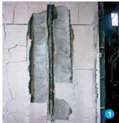
1. Estado de un panel de yeso cartón luego de un ensayo RF.
