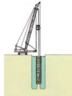
3. Excavación de la tercera zanja que completa el primer tramo de pared moldeada.
