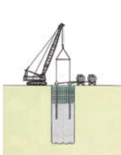
5. Hormigonado del primer tramo de pared moldeada.
