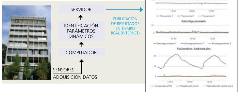
**FIGURA 3.** EDIFICIO CÁMARA CHILENA DE LA CONSTRUCCIÓN. VISTAS Y DISPOSICIÓN DE ACELERÓMETROS
