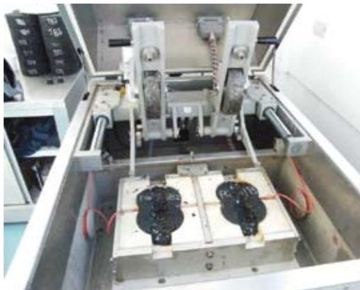
**Ensayo de ahuellamiento.**
