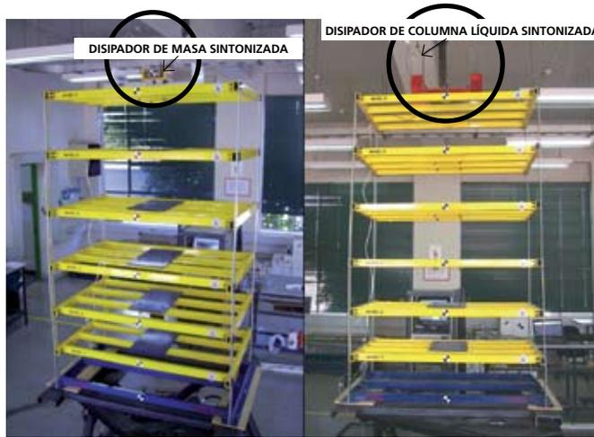
aceleración de base. Para esto se instaló un disipador de masa sintonizada y un disipador de columna líquida sintonizada en el nivel superior de la estructura, figura 4. Para realizar posteriores análisis comparativos ambos dispositivos poseen una masa que corresponde a un 3,1% de la masa total del modelo.
