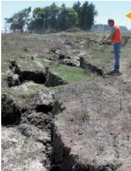
Por licuefacción del subsuelo, bloques de suelo superficial se trasladaron y rotaron, fenómeno conocido como desplazamiento lateral, lo cual es la evidencia más común de las capas del subsuelo con pérdida de resistencia a causa de licuefacción.
