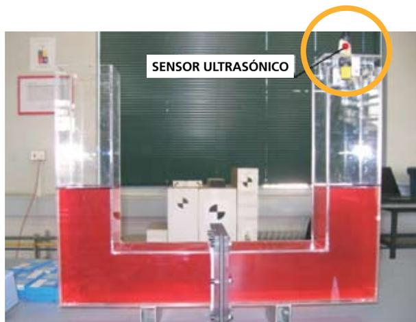
**FIGURA 2.** Disipador de columna líquida sintonizada utilizado en los análisis experimentales. El líquido utilizado es agua el cual ha sido coloreado para hacerlo visible. Un sensor ultrasónico ubicado en la parte superior de las columnas verticales permite la medición del desplazamiento de la superficie libre de líquido.
