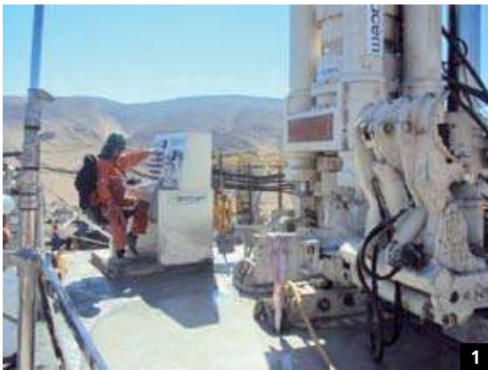
PLAN A. Compuesto de una máquina Raise Borer Strata 950. 1. Operador accionando los sistemas de control. 2. Vista general de la sonda.
