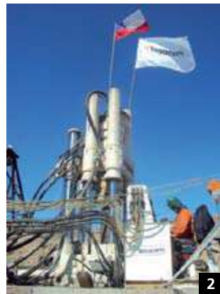
PLAN A. Compuesto de una máquina Raise Borer Strata 950. 1. Operador accionando los sistemas de control. 2. Vista general de la sonda.
