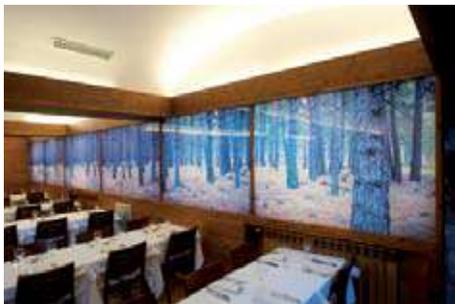
Se trata de un vidrio sobre el que se deposita un motivo original en esmalte opaco o translúcido mediante una serigrafía (pantalla textil), que se cuece rápidamente a altas temperaturas. Posteriormente el vidrio es templado. Este procedimiento aporta estabilidad y gran durabilidad en el tiempo al producto, que está disponible en el mercado español.
