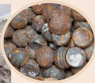
Por dentro, el cajón de hormigón se rellena con esferas de acero de entre 7 y 10 cm de diámetro, aproximadamente. Para evitar los vacíos dentro de la masa y aprovechar al máximo los espacios, a medida que se introducen las esferas, se rellena con lechada. Terminando con una capa de ésta, para sellarlo. Este sistema permite optimizar los espacios, generando masas de mayor densidad, obteniendo así un mayor peso a través del relleno de los cajones.
