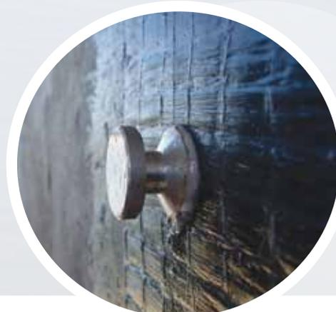
Ensayo de adherencia ASTM 4541 realizado por IDIEM al sistema de refuerzo.
