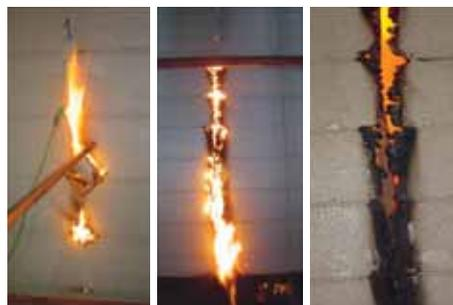
**FIGURA 1.** Vista una probeta con perfilería metálica y revestimiento tinglado donde se aprecia la falla y la deformación del montante metálico.
