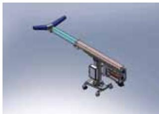
dar”, asegura el Gerente de Calidad. Además, los motores están montados en la zona de los contrapesos, sobre la viga del carro terraza, lo que evita riesgo de sobre carga. “A diferencia de los carros tradicionales, CT-350 tiene el motor posicionado en la azotea y no en el carro mismo; por lo tanto estos son un 60% más livianos maximizando por tanto la capacidad de carga dentro del andamio”, agrega Claudio.
