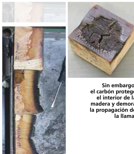
Sin embargo, el carbón protege el interior de la madera y demora la propagación de la llama.
