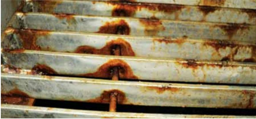
Grating de acero inoxidable contaminado con agua de mar. La acción de los cloruros acelera el proceso de corrosión, sobre todo si no se tiene cuidado con la estructura.
