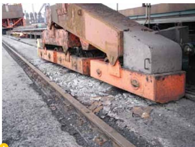
Las estructuras portuarias se vieron mucho más afectadas por el posterior tsunami que por el movimiento telúrico. Las grúas que no contaban con ganchos antisísmicos en sus sistemas rodantes, se descarrilaron.
