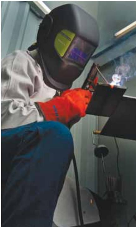
**Una buena identificación del material a soldar y su espesor, permitirá seleccionar la soldadura y el diámetro adecuado.**
