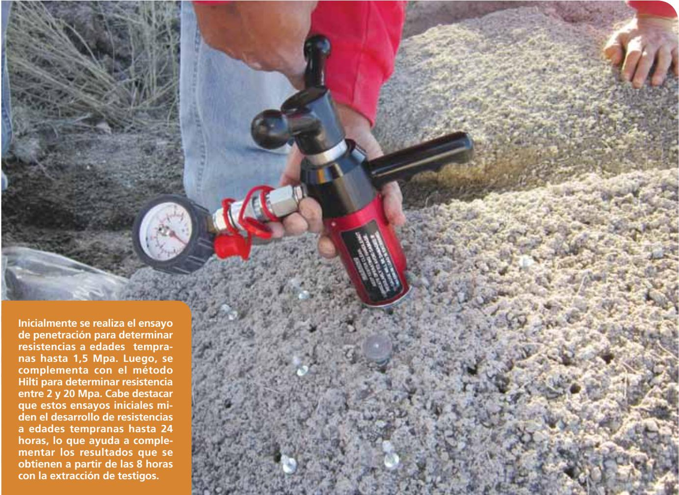
Inicialmente se realiza el ensayo de penetración para determinar resistencias a edades tempranas hasta 1,5 Mpa. Luego, se complementa con el método Hilti para determinar resistencia entre 2 y 20 Mpa. Cabe destacar que estos ensayos iniciales miden el desarrollo de resistencias a edades tempranas hasta 24 horas, lo que ayuda a complementar los resultados que se obtienen a partir de las 8 horas con la extracción de testigos.
