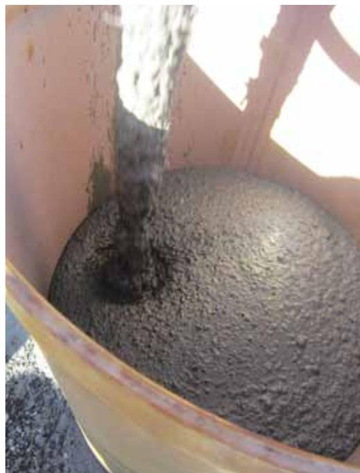
El primer paso, es agregar la dosis de diseño del aditivo. Esta se agrega en su totalidad en un porcentaje del agua de amasado (80-90%) en el momento de iniciar el mezclado mecanizado.
