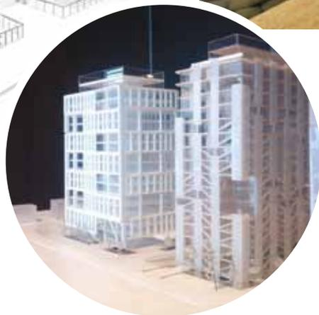
La segunda parte del proyecto, se espera finalice en diciembre de 2013. El edificio contará con plantas libres, con losas condensadas de 16 cm. En su fachada tendrá vigas de 6 m de alto por 20 m de largo, de alma vacía.
