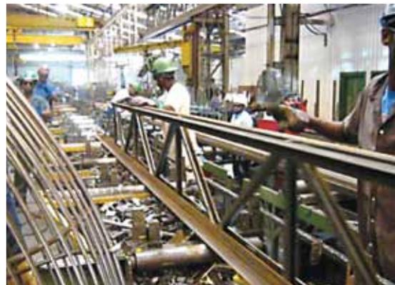
El sistema constructivo está elaborado con perfiles de acero reciclado y laminado en caliente. El trabajo de fabricación se realiza sobre una mesa especial con el objetivo de aumentar la productividad en la línea de producción. Este proceso fue desarrollado en Estados Unidos y adaptado con equipos propios, diseñados y fabricados en Chile.
