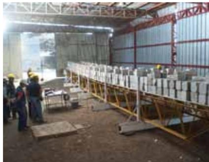
En el ensayo, la máxima deformación que alcanzó la viga antes del colapso fue de 238 mm, lo que equivale a una deformación de L/75 (L/75 indica que si se divide el largo de la viga en 75, da una deformación de 238 mm). Una viga en su estado normal de cargas, para este tipo de luces, presenta una deformación de no más de 75 mm equivalente a L/240. "Es una condición de diseño y significa que no se puede flexar más del largo de la viga dividido por 240".
