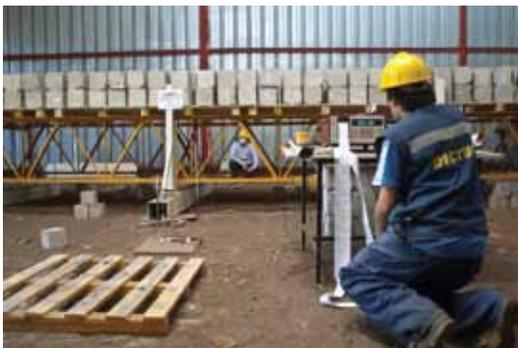
El sistema fue sometido a una prueba de carga con cubos de hormigón que comúnmente se emplean en pruebas de calidad para obras. Un operador, a través de un equipo electrónico, midió la deformación de la viga hasta llevarla al colapso. Los factores de seguridad en el diseño, indican una sobre resistencia del orden de 2,17 veces más de lo que aparece en el manual antes del colapso.
