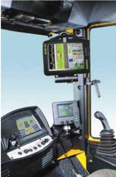
Además de los sensores de vibración, los rodillos tienen tecnología de posicionamiento (GPS) integrada en software en tiempo real que se muestra al operador.
