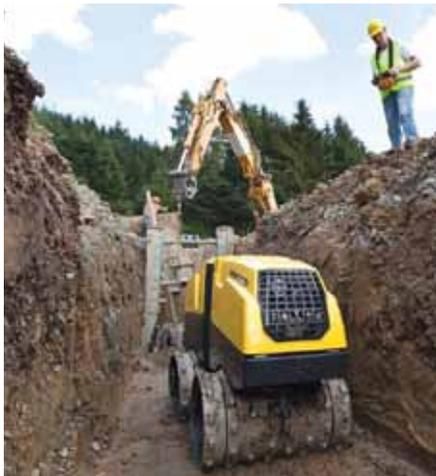
**El Compactador Multipropósito BMP 851 (BOMAG) puede ser manejado a control remoto, lo que entrega mayor seguridad a sus operarios.**
