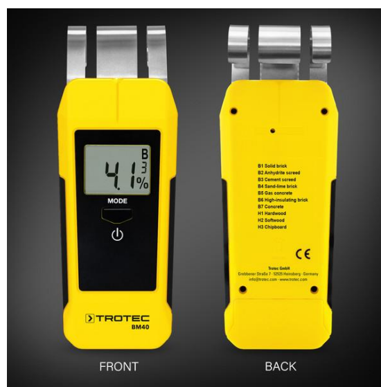
Figura 7: Imagen del medidor de humedad de superficie, en la cual, solo se utilizó la opción “B7” (Concrete) y “H3” (Chipboard).
